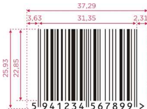
Figura 3 – cod de bare in simbologia EAN-13 cu un raport de mărire de 100% (în milimetri)
