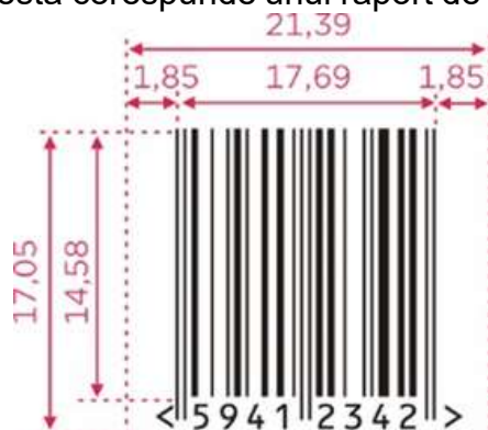
Figura 4 – Cod de bare în simbologia EAN-8 cu un raport de mărire de 80% (în milimetri)
