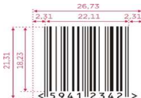
Figura 5 – Cod de bare in simbologia EAN-8 cu un raport de mărire de 100% (în milimetri)
