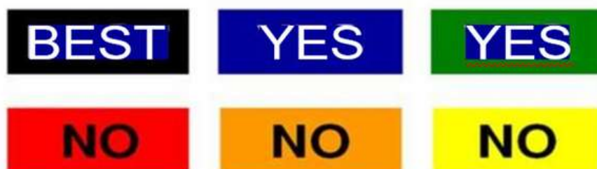
Figura 8 - Selecția culorilor permise și nepermise în codul de bare
