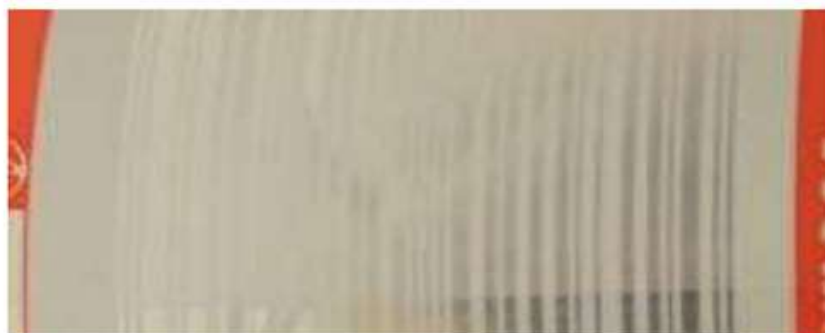
Figura 13 - Cod de bare cu contrast redus
