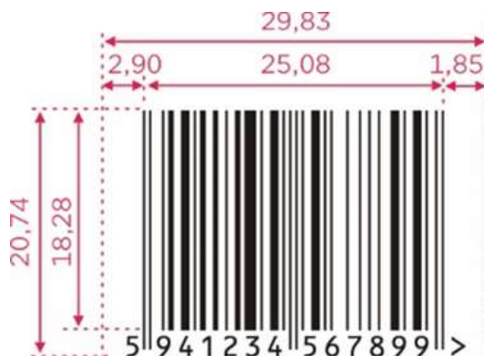
Figura 1 – cod de bare in simbologia EAN-13 cu un raport de mărire de 80% (în milimetri)
